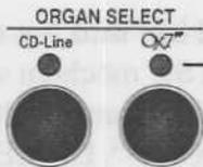
3) Drücken Sie im Anschluß die Taste OX/UP, Das Kürzel im Display Ihres OX7UP zeigt an, daß der DEMO PLAY Modus aktiv ist. Die LED über der Taste OX7UP blinkt jetzt in schneller Folge.
