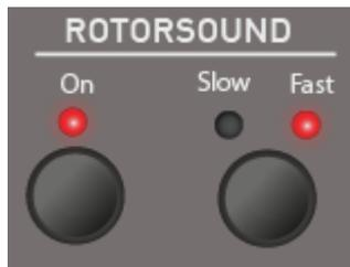
Mit der Taste Rotorsound ON werden die Zugriegel über den Rotor-Effekt geleitet. Der Rotor ist eine Simulation eines speziellen Verstärkers mit mechanisch rotierenden Lautsprechern. Durch die Rotation der Lautsprecher wird physikalisch ein Dopplereffekt erzielt, der sich in einem komplexen Frequenz- und Phasenvibrato auswirkt.
