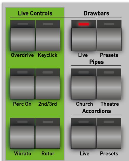
**Overdrive** = Schaltet zu dem Zugriegelklang einen Verzerrereffekt hinzu (nur bei VB3). Bei den früheren elektromechanischen Instrumenten ist dieser Klang durch die weiche Röhrenübersteuerung eines angeschlossenen Rotor-Cabinets entstanden.
