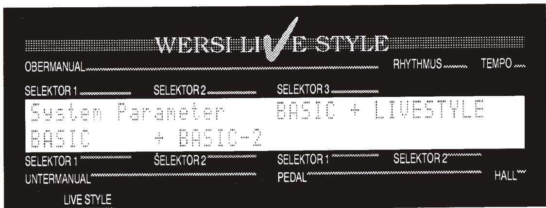
Die beiden LIVE STYLE-Ebenen sind abgeschaltet. Mit dem BASIC-Taster können nun die Ebenen BASIC und BASIC-2 (MEGA-Sounds) eingestellt werden.
