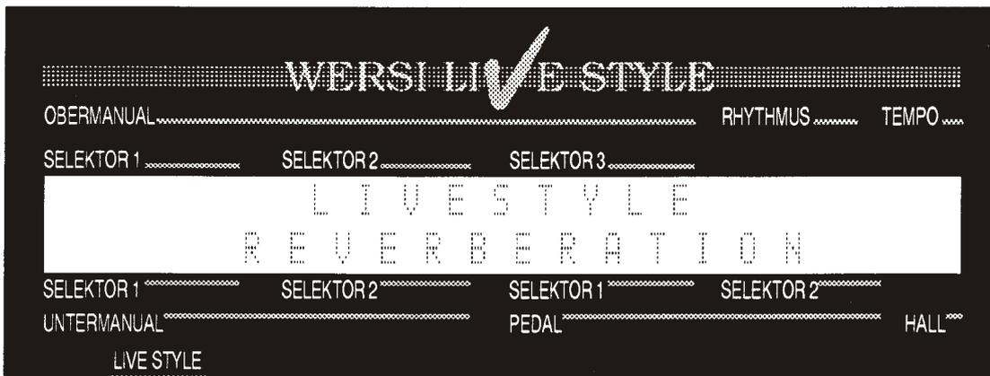
Diese Anzeige bedeutet, das nun der ISP-Hall für die LIVE STYLE - Klangfarben angewählt ist (Reverberation = engl. Hall). Sie können jetzt, wie gewohnt, mit dem Taster "Digital Hall" im Bereich SOUND CONTROLS aus 8 verschiedene Halleinstellungen A, B, C ....bis H auswählen und dann mit dem Hall-Schieberegler eine Hall-Lautstärke einstellen. Die gerade angewählte Einstellung erscheint auch im Display im Bereich "HALL".
