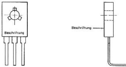
Abb. 21: Kleinleistungstransistor, z.B. BD 138, BD 178
