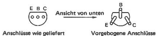
Abb. 18: Anschlüsse des Transistortyps nach Abb. 19
