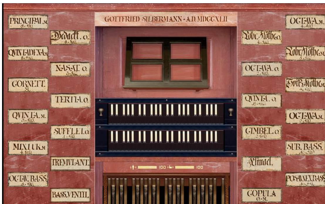
Die Abbildung zeigt die Bedienoberfläche einer Sakralorgel von Gottfried Silbermann. Die zweimanualige Orgel der evangelischen Stadtkirche in Zöblitz/Erzgebirge baute Silbermann im Jahre 1742.
