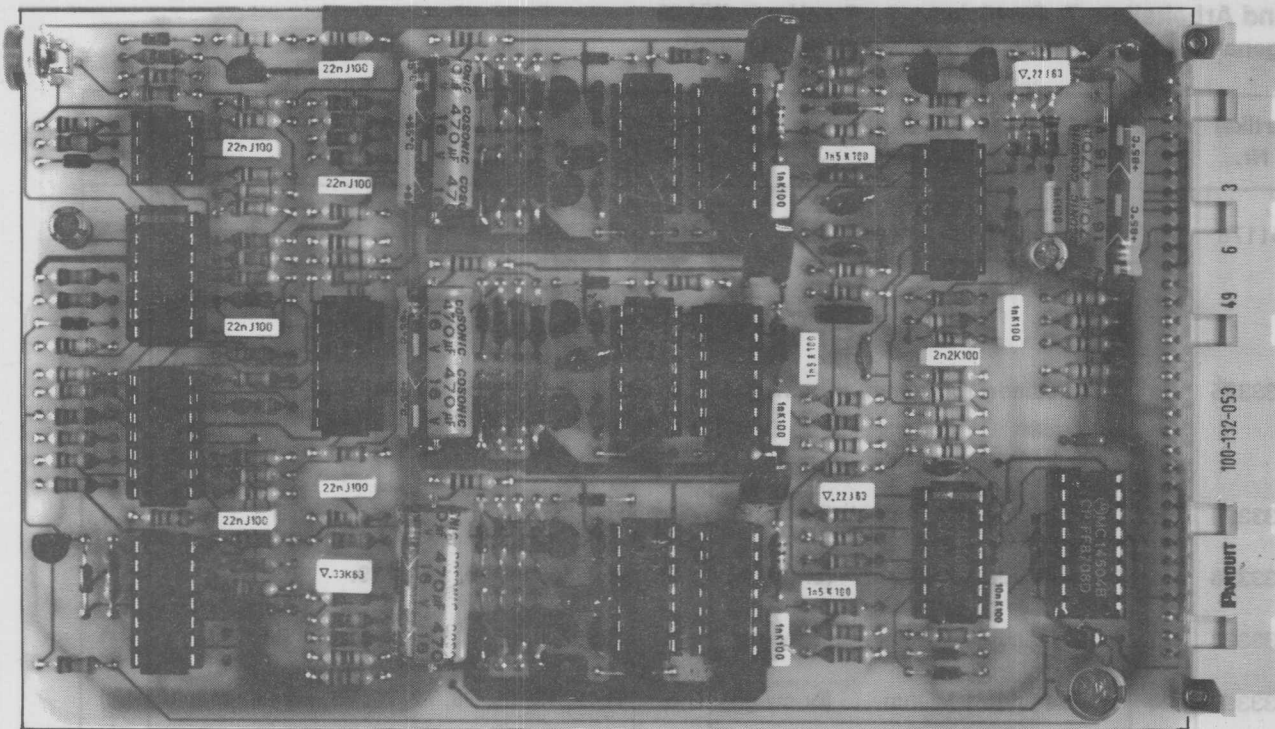
Abb. 15: Fertig bestückte Platine WV 30
